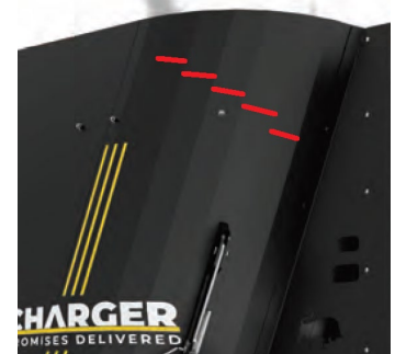
БУНКЕР HYPERMIX Бункер с ребрами жесткости разработан для лучшей геометрической целостности
