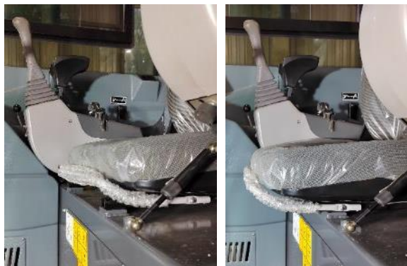
Кресло оператора с регулировкой дальности и наклона спинки, подголовником
