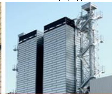
Полностью теплоизо- лированная шахта
