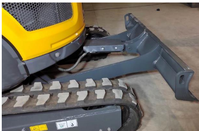
Усиленная конструкция отвала, серповидная форма режуще-толкающей кромки
