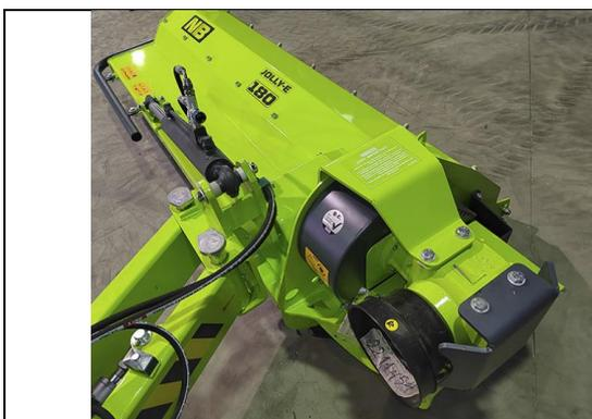
Редуктор Jolly-E расположен левее режущей головки и ременной коробки
