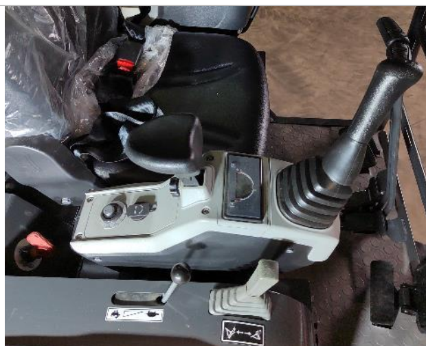
Джойстики с эргономичным наклоном, регулируемые упоры для предплечья Пилотное управление гидравлическими функциями
