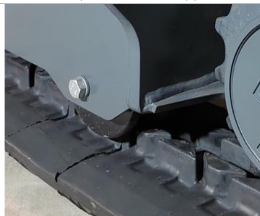
Гусеничные ленты с направляющими трапецевидной формы для сокращения вибраций долговечности ходовой части
