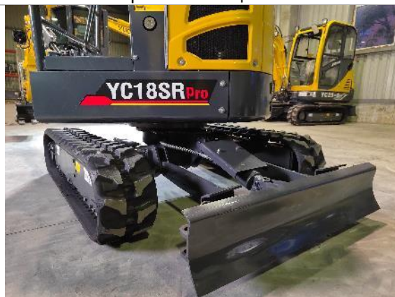
Расширяемое шасси с направляющими U образной формы
