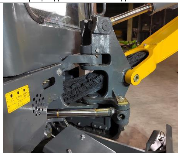
Литой кронштейн стрелы Верхнее расположение г/ц для его безопасности РВД проложены в стреле для их безопасности
