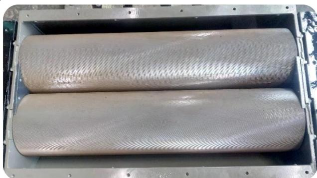
**Система мгновенного отскока**, является запатентованной разработкой ROMILL. Эта система защищает вальцы от попадания между ними неразрезных объектов, таких как камни, металлические части и т.д.
