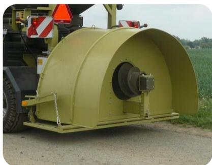
**Пресс-туннель** не входит в набор базового оборудования. Поскольку машина выполняет еще и роль упаковщика, она может использоваться с пресс-туннелем диаметром 5 или 6,5 футов. Пресс-туннель можно легко заменить в случае необходимости замены размера пластиковых рукавов.
