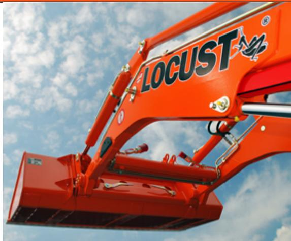
Благодаря телескопической стреле, высота подъема минипогрузчика Locust L1203TELSPEED по шарниру составляет 4070 мм, такой показатель недостижим, ни одним минипогрузчиком аналогичного класса других производителей, не оснащенным телескопической стрелой. Это позволит без труда загружать любые грузовые автомобили, даже с высокими бортами.
