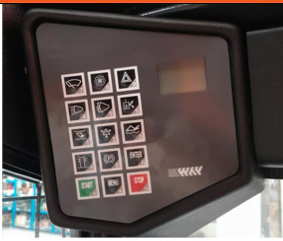
Минипогрузчики Locust максимально технологичны, удобная панель с контактными кнопками и ЖК дисплеем позволяет в режиме реального времени контролировать все функции минипогрузчика. Кнопочный замок зажигания позволяет осуществлять бесключевой запуск двигателя.
