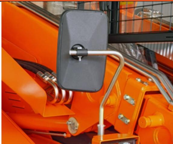
Зеркала бокового обзора закреплены на раме погрузчика, а не на стреле, как это бывает у некоторых минипогрузчиков других производителей, что позволяет сохранить прекрасную обзорность рабочей зоны во время движения погрузчика Locust даже при поднятой стреле.
