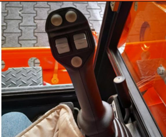
Гидравлические джойстики управления типа «Н» представляют собой совместное управление. Удобное расположение дополнительных кнопок прямо на джойстиках позволяет оператору работать максимально эффективно. Управление гидравлическими джойстиками позволяет передвигаться и работать более плавно и точно.
