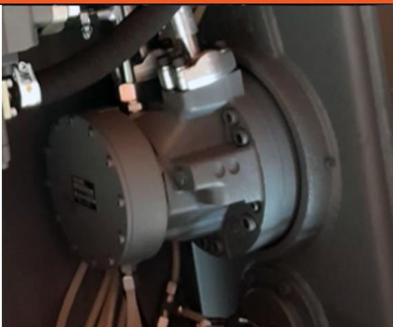
Применение в конструкции мини-погрузчика мощных гидравлических радиально-поршневых моторов REXROTH MCR 5 обусловлено достижением эффекта пониженного нагревания гидравлического масла, что значительно расширяет предельное время непрерывной работы в режиме максимальной нагрузки. Двухскоростной режим позволяет достигать скорости передвижения в 19 км/час.
