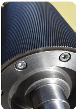
**Вальцы** – это сердце и главный рабочий орган всех машин ROMILL. Уже в базовой комплектации они оснащены кожухами, выполненными по технологии азотирования стали. При высокотемпературном азотировании рабочей поверхности происходит насыщение стальной оболочки ионами азота. Это необходимо для повышения твёрдости, износоустойчивости и коррозионной стойкости, а также для приобретения лучших триботехнических свойств. Ресурс вальцов в стандартной комплектации составляет до 25 000 тонн.
