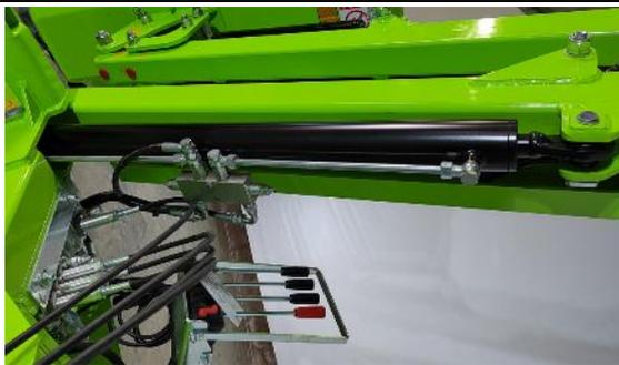
Гидрозамок на цилиндре стрелы – автоматическая блокировка при транспортировке
