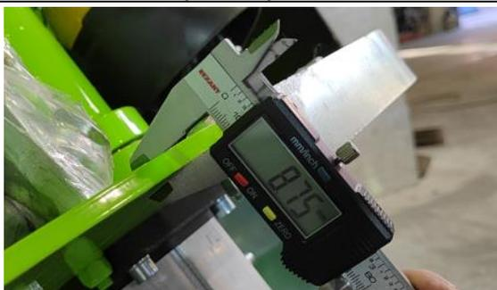
Режущая головка из стали толщиной 8,7 мм
