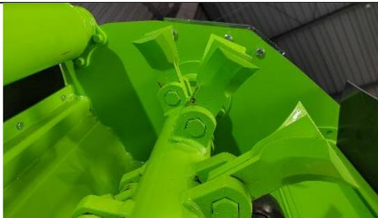
Резцы расположены на роторе спирально для снижения нагрузки во время резания
