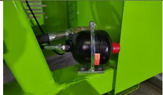
Пневматический гидроамортизатор стрелы
