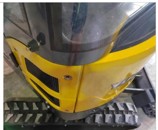
Нулевой вынос задней части поворотной надстройки
