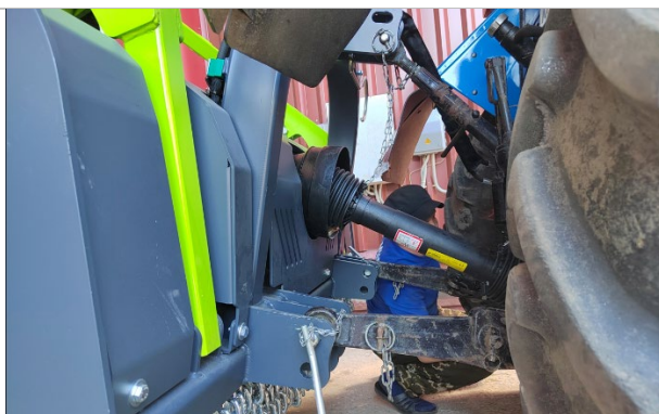
Трехточечная навеска с двумя парами крепления, верхняя точка с подвижным шарниром
