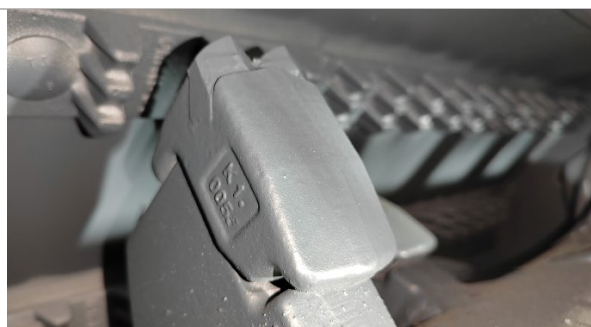
Резцы с двумя вставками карбида вольфрама
