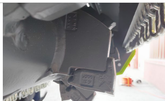
Сложная форма резца для защиты от проворота
