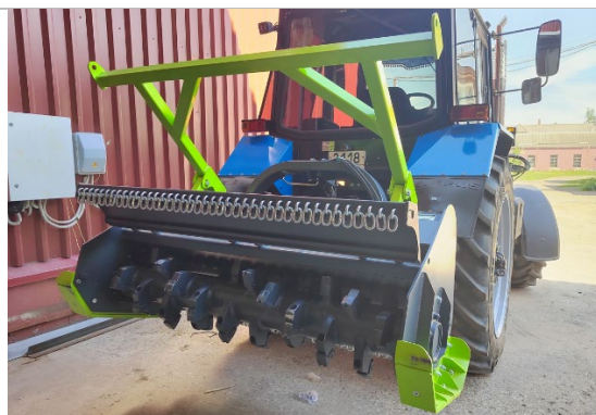
Мощный корпус, толщина листовой стали до 10 мм
