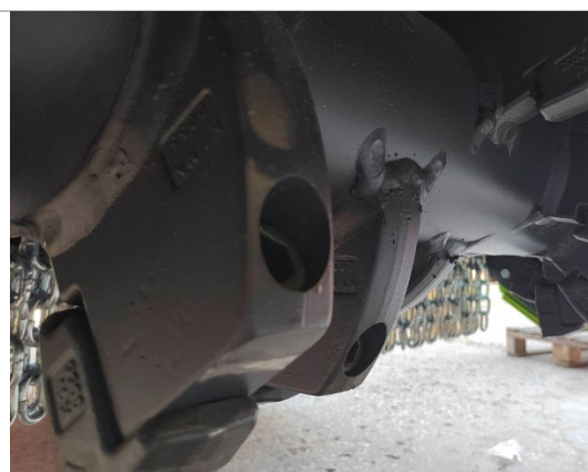
Крепление резца усиленным винтом
